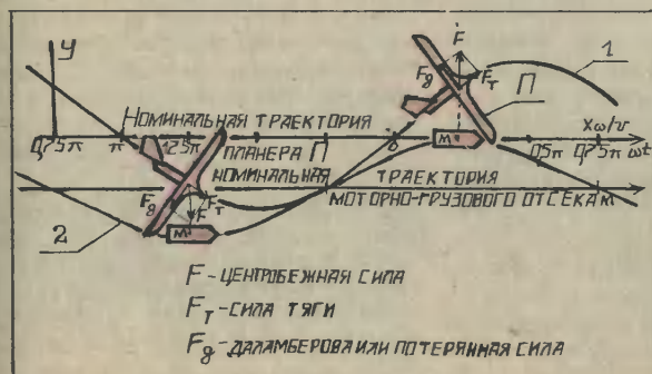
Схема разложения сил, позволяющая понять физические основы полета по новому принципу.
